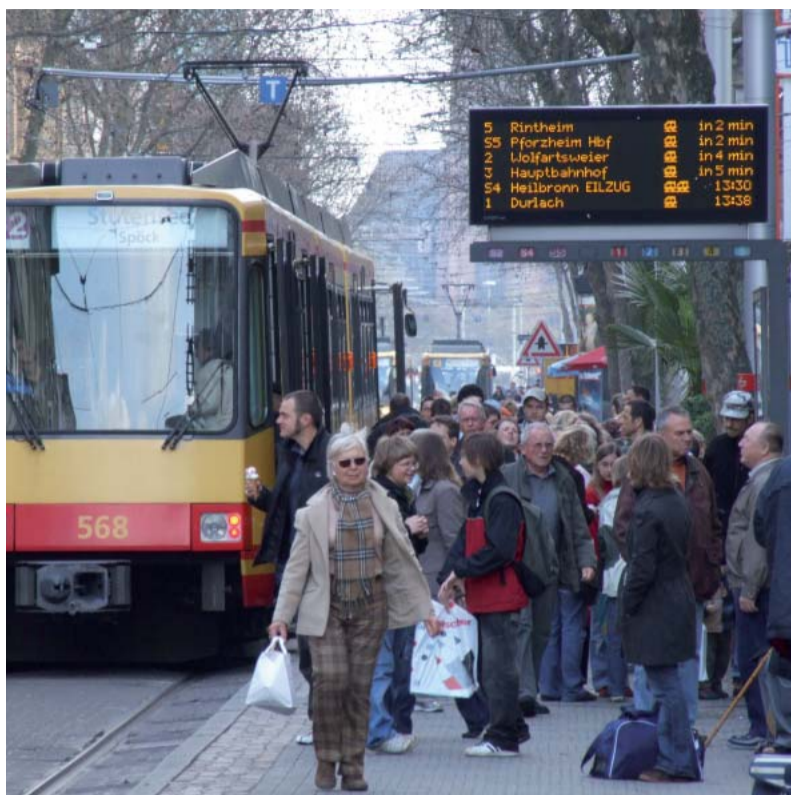
K moderní městské veřejné dopravě patří tzv. „inteligentní zastávky“. Elektronické informační panely přijímají aktuální data z centrálního dispečinku a usnadňují orientaci cestujících ve všech situacích. Tento snímek je z německého města Karlsruhe. Foto Jiří Kohout
