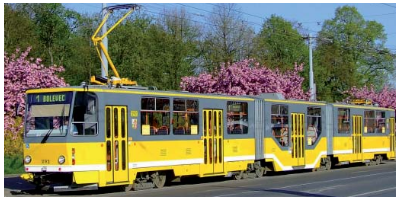
U modernizovaných tramvají KT8D5-RN2P s složeným nízkopodlažním článkem je zachována možnost jejich obousměrného provozu, tj. dvě kabiny řidiče a dveře na obou stranách. Foto J. Šlehofer
