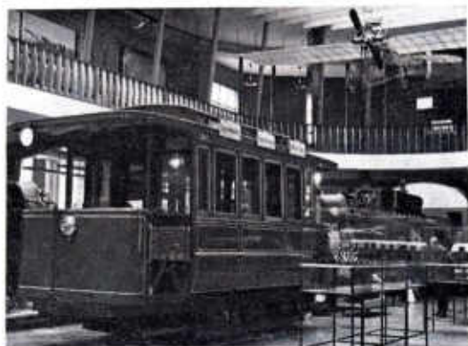
Abb. 3 – Im Budapester Eisenbahn-Museum – Strassenbahnwagen aus der ersten Serie der Normalspurwagen, Baujahr 1899. Dieser Typ wurde in den 20er Jahren zum Bw umgebaut, später sogar Zwilling-Bw und im 2. Weltkrieg ausgemustert.
