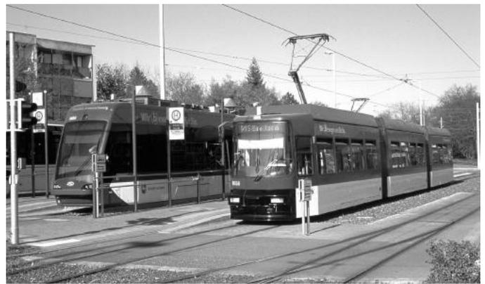
Tramino und LHB/AEG-Niederflurtriebwagen
