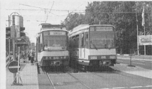
Die baulichen Unterschiede der beiden Generationen von Mehrsystem-Hochflurwagen GT8-100C/2S und GT8-100D/2S-M aus den 1990er Jahren werden auf dieser Gegenüberstellung deutlich.
