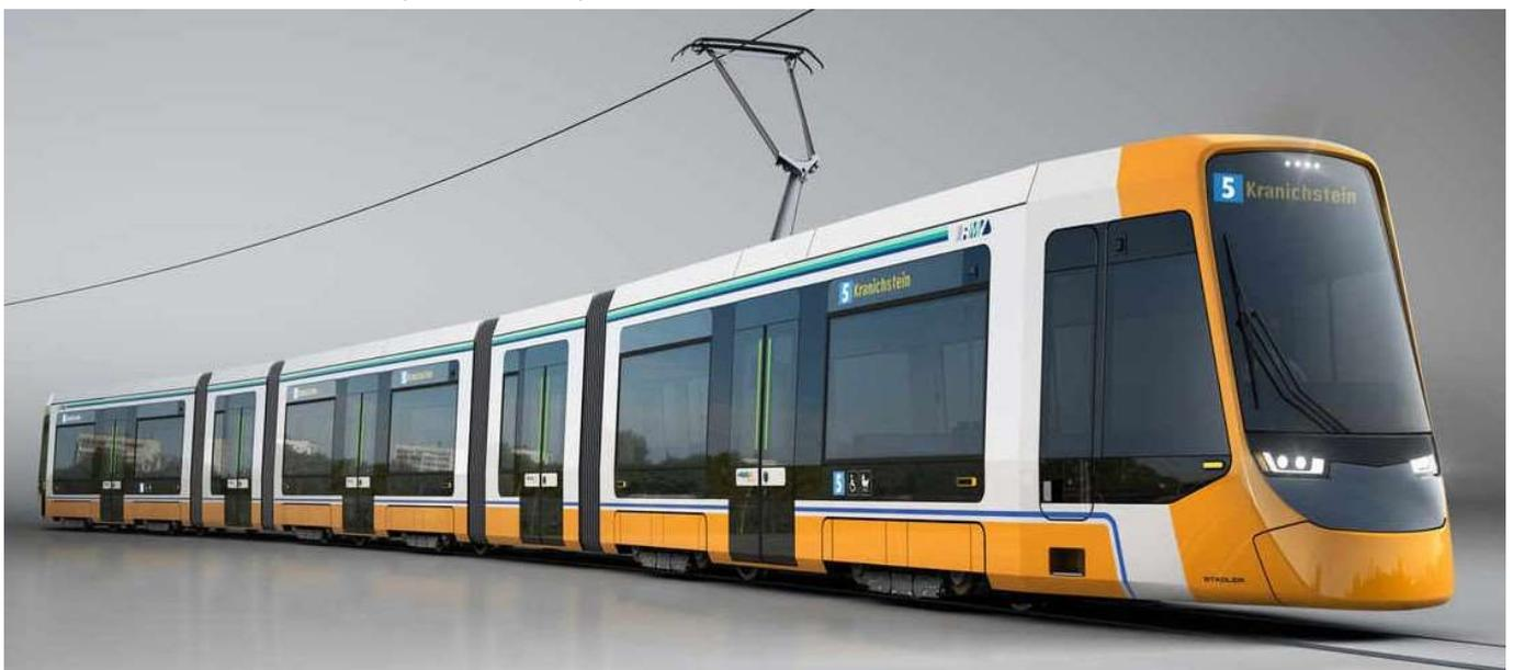
**Neuentwickelte Niederflurtram TINA (Total Integrierter Niederflur-Antrieb) von Stadler Rail aus Bussnang, hier das ursprüngliche Layout für die HEAG in Darmstadt, anstatt bisher auf Festgestellen nunmehr auf neu entwickelten Drehgestellen, mit durchgängig niederflurigem Fahrgastbereich zwischen den Türen. (Grafik: Stadler)**
